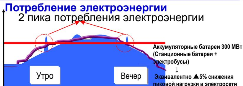
Сдвиг пиков электропотребления за счет применения распределенной системы аккумуляторных батарей
