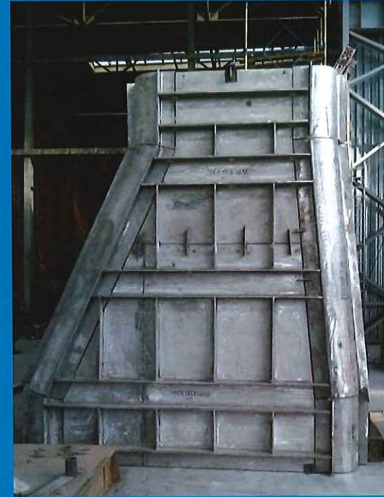
HRSG Diffuser Chelyabinskaya TPP-1
