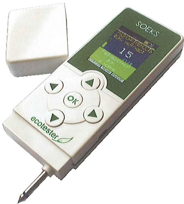
Экотестер "СОЭКС" предназначен для экспресс-анализа содержания нитратов в свежих овощах и фруктах, а так же для оценки уровня радиоактивного фона и обнаружения предметов, продуктов питания, строительных материалов, зараженных радиоактивными элементами.
