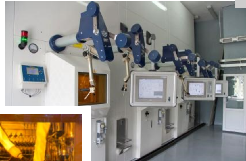
«Hot» cameras with manipulators
